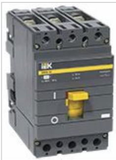
Предназначены для проведения тока в нормальном режиме и отключения тока при коротких замыканиях, перегрузке, недопустимых снижениях напряжения, а также для оперативных включений и отключений участков электрических цепей и рассчитаны для эксплуатации в электроустановках с номинальным рабочим напряжением до 400 В и на номинальные токи от 12,5 до 1600 А.
