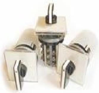
Переключатели серии ПМО предназначены для коммутации электрических цепей управления, сигнализации и защиты напряжением от 12 до 220 В постоянного тока и от 24 до 380В переменного тока частотой 50, 60 и 400 Гц при токах от 0,25 до 6,3А в стационарных установках.
