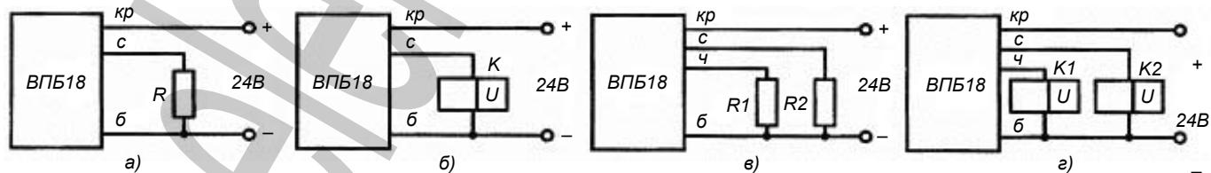
Подключения выключателей со структурой выхода р-н-р к нагрузке:
