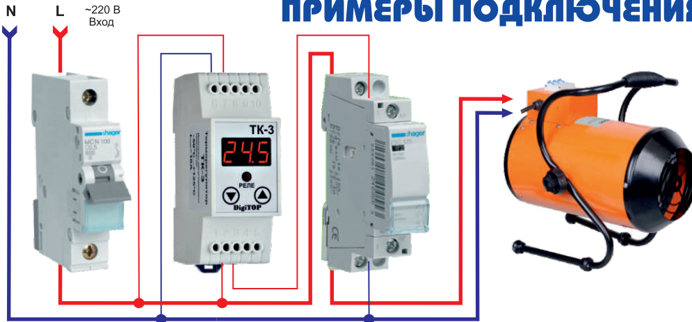
Пример комплектации блока управления обогревателем с использованием терморегулятора ТК-3
