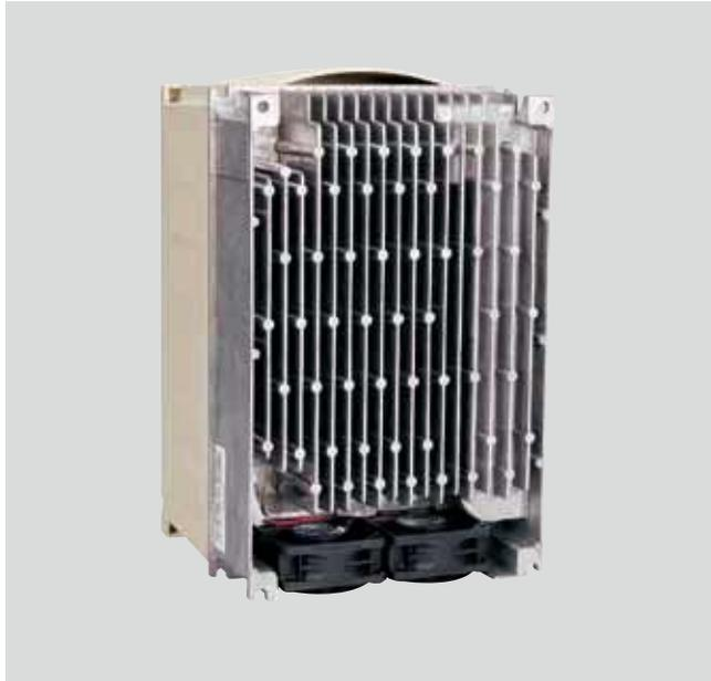
В CFW-09 использован особый подход к системе монтажа. Помимо традиционного способа базовой установки включена возможность навесного фланцевого монтажа, при котором пластина цинкового теплообменника монтируется позади крепежной панели, как показано на рисунке. В результате, теплый воздух, образующийся греющимися энергоэлементами внутри панели, выходит наружу, уменьшая внутреннюю температуру панели. Такое исполнение позволяет уменьшить размер панели и снизить требования к вентиляции.
