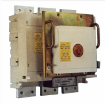
Выключатели предназначены для проведения тока в нормальном режиме и отключения тока при коротких замыканиях, перегрузках и недопустимых снижениях напряжения, а также для нечастых (до 6 часов) оперативных включений и отключений электрических цепей и рассчитаны для эксплуатации в электроустановках на номинальное напряжение до 440 В переменного тока частотой 50 и 60 Гц.
