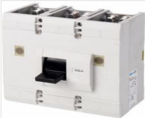
Выключатели автоматические типов ВА51-39 и ВА52-39 предназначены для проведения тока в нормальном режиме и отключения его при коротких замыканиях, перегрузках и недопустимых снижениях напряжения, а также нечастых (до 6 раз в сутки) оперативных включений и отключений электрических цепей.
