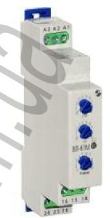
В исходном состоянии и при выключенном исполнительном реле замкнуты контакты 15-16 и 25-26. Индикатор светится зеленым цветом. При срабатывании исполнительного реле замыкаются контакты 15-18 и 25-28, индикатор светится оранжевым цветом.
