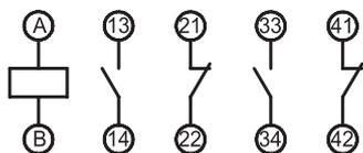
Реле электромагнитные постоянного тока серии РЭВ 800 применяются в схемах автоматического управления в качестве электромагнитных реле времени (РЭВ 811 - РЭВ 818, РЭВ 880), контроля тока (РЭВ 830), контроля напряжения (РЭВ 821, РЭВ 825) и промежуточных (РЭВ 822, РЭВ 826), в том числе и электрооборудования вагонов метрополитена (РЭВ 811Т - РЭВ 814Т).
