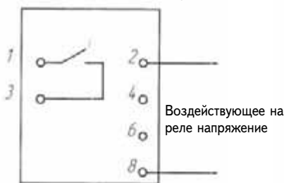
Рисунок 3 – Схема электрическая подключения реле PH 51.
