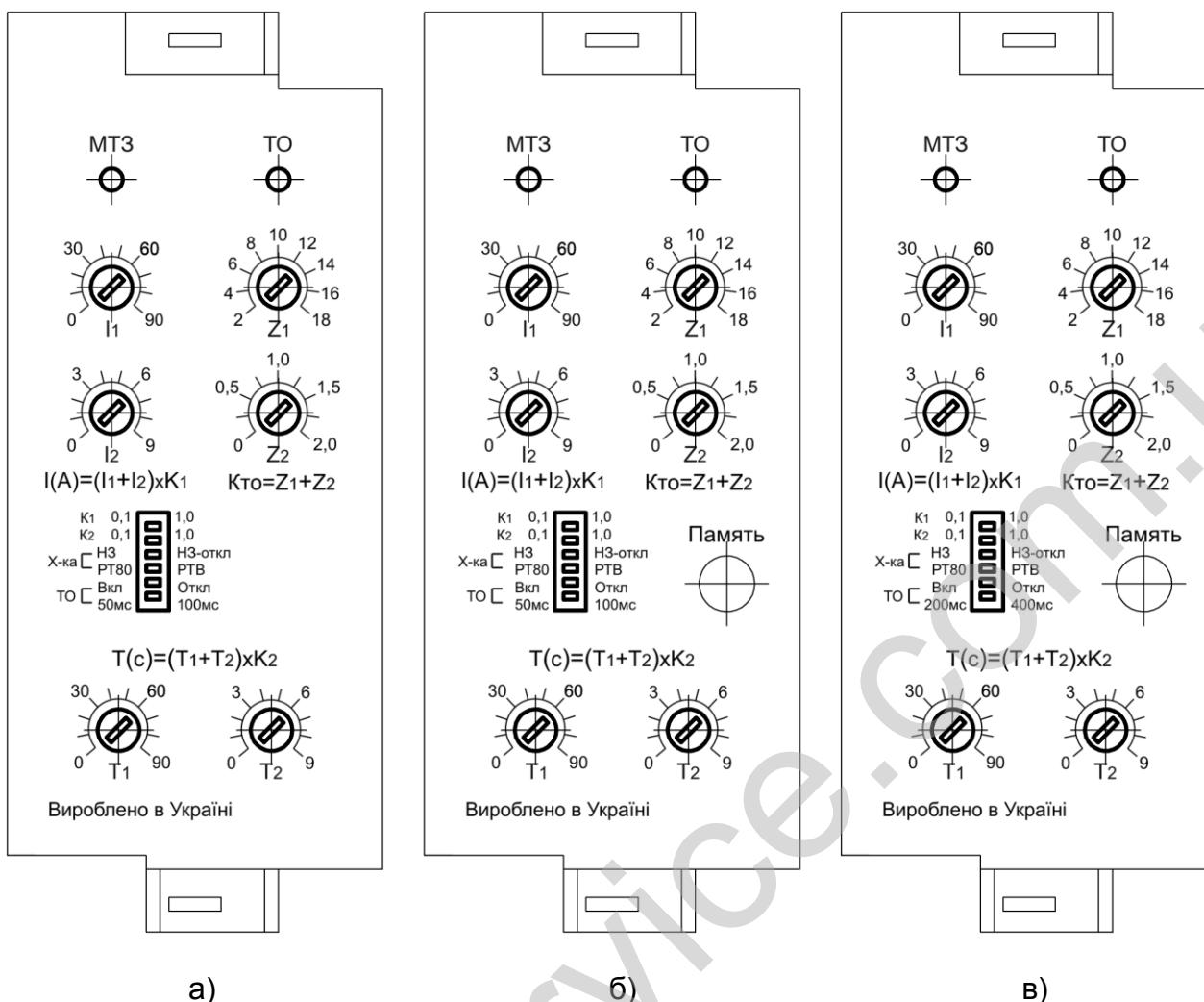
Рисунок 4 – Внешний вид лицевой панели и органов управления реле
