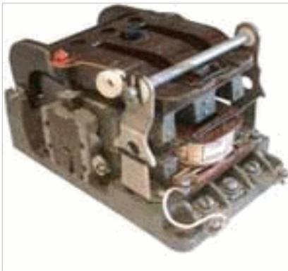
**Пускатели электромагнитные серии ПАЕ** предназначены для дистанционного управления электродвигателями и другими электроустановками. Они обеспечивают нулевую защиту, т. е. при исчезновении напряжения или его снижении до 50-60% от номинального катушка не удерживает магнитную систему пускателя, и силовые контакты размыкаются. При восстановлении напряжения токоприёмник остаётся отключенным. Это исключает возможность
