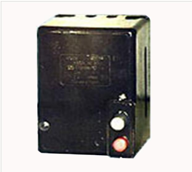
**АП 50Б-2МТ** - серия автоматических выключателей, предназначенных для защиты от перегрузок и коротких замыканий электрических цепей напряжением до 220 В постоянного тока, до 500 В переменного тока частоты 50- 60 Гц, оперативных включений и отключений указанных цепей с частотой от 6 до 30 включений в сутки, в том числе для пуска, защиты и остановки электродвигателей.
