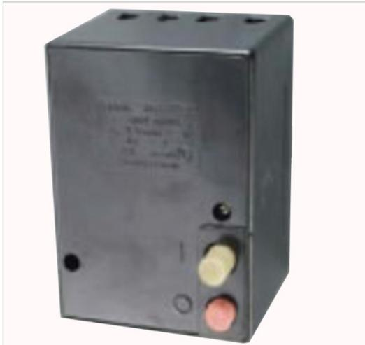
Автоматические выключатели **АП 50 3МТ** предназначены для защиты от перегрузок и коротких замыканий электрических цепей напряжением до 220В постоянного тока, до 500В переменного тока частоты 50-60 Гц, оперативных включений и отключений указанных цепей с частотой от 6 до 30 включений в сутки, в том числе для пуска, защиты и отключения электродвигателей.
