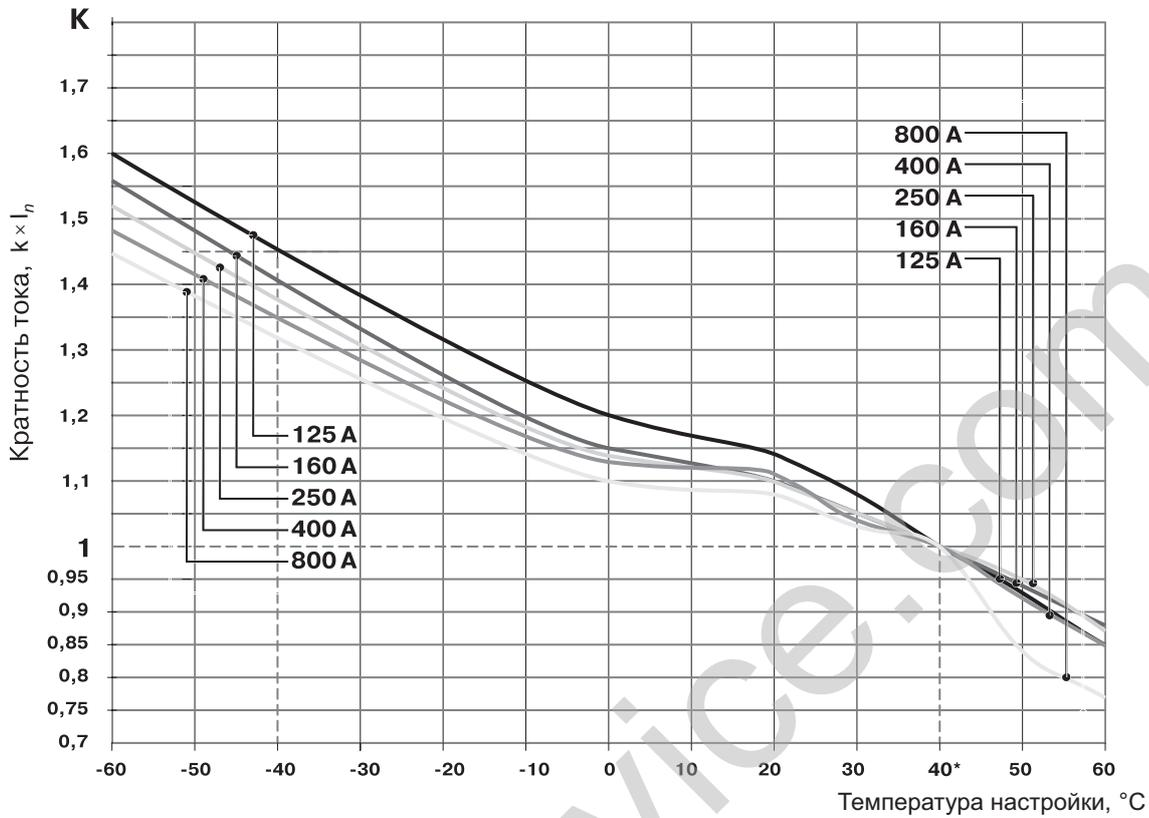
Характеристика токоограничения выключателей при напряжении 400 В
