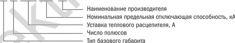
Пример обозначения выключателя при заказе и в документации другого изделия: выключатель автоматический в исполнении 33-го габарита трехполюсный на номинальный ток 125 А с номинальной предельной отключающей способностью 35 кА торговой марки IEK® – ВА88-33 3Р 125А 35кА ИЭК.
