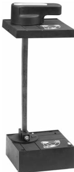
Привод закрепляется на двери распределительного устройства для оперирования выключателем через дверь. Он снабжен устройством для навесного замка блокировки в отключенном состоянии. Может быть установлено до трех замков с диаметром дужки 6 мм (в комплект не входят).
