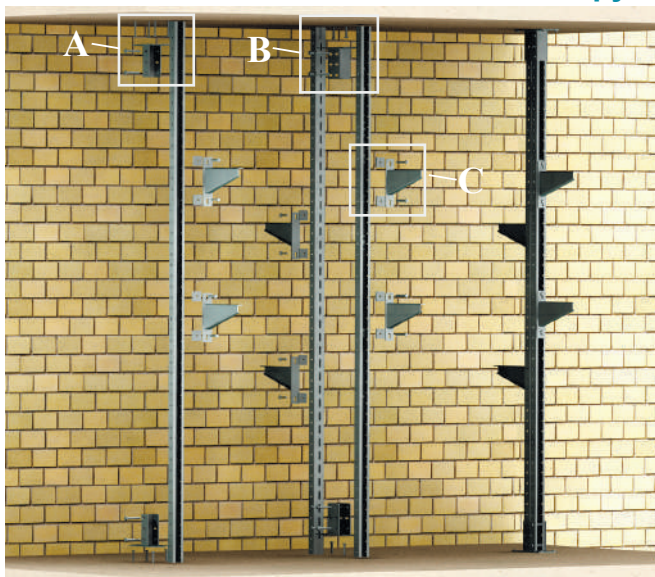
I етап – монтаж станин до стелі й підлоги в розпір планкою відповідної довжини
